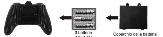
**Installazione delle batterie:** Aprire il coperchio del vano batteria. Inserire le 3 batterie AA da 1,5V secondo la polarità indicata (batterie non incluse).
