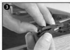
3 Separera försiktigt kassetten från uttaget.
