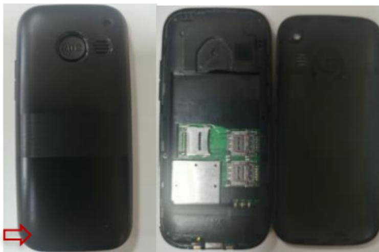
Inserte la tarjeta SIM en el soporte tal y como se ilustra debajo con el chip dando hacia abajo. No se incluyen las tarjetas SIM. Las tarjetas SIM y el punto de contacto se dañarán con facilidad debido a arañazos y dobleces. Tenga cuidado.
