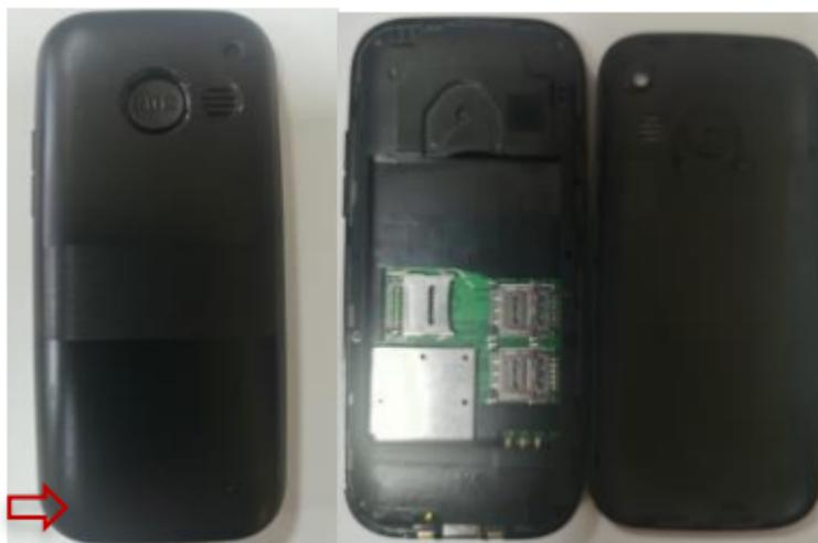
Setzen Sie die SIM-Karte(n) wie in der nachstehenden Abbildung gezeigt in den Halter ein, wobei der Chip nach unten zeigt. SIM-Karten sind nicht im Lieferumfang enthalten. SIM-Karten und Kontakte können leicht verkratzen und verbogen werden. Seien Sie entsprechend vorsichtig.
