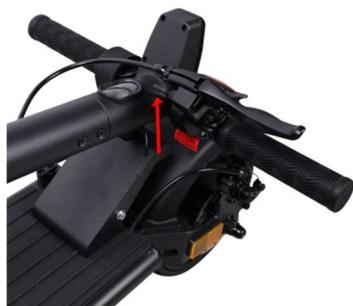
3) Schließen Sie den Verriegelungshebel am unteren Ende der Steuerrohraufnahme.
