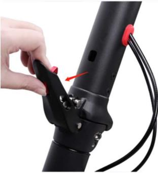
2. Öffnen Sie den Entriegelungshebel vollständig.
