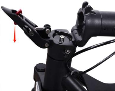
4. Sichern Sie anschließend die nach unten geklappte Lenkstange mit dem hierfür vorgesehenen Haken.
