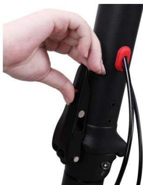
4) Wenn Sie hören, wie das Steuerrohr einrastet, ist der Elektroroller ordnungsgemäß aufgeklappt.
