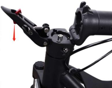
3. Klappen Sie dann den Elektroroller zusammen, indem Sie die Lenkstange nach unten führen.
