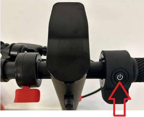
Die Beleuchtung schalten Sie ein und aus, indem Sie bei beleuchtetem Display einmal die Ein/Aus-Taste drücken.
