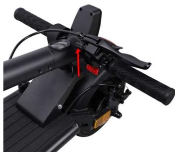
3) Fermez le levier de verrouillage situé sur la partie inférieure du tube support du guidon.
