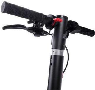
2). Après avoir fait correspondre les trous du guidon avec ceux du châssis, insérez les vis et serrez-les bien. Répétez l'opération également sur le côté opposé du guidon. Les 4 vis doivent être utilisées.
