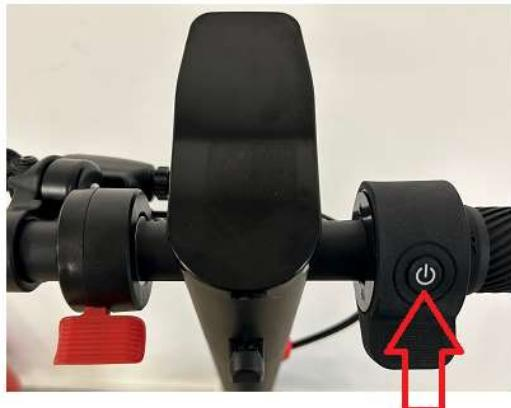
Kad je zaslon romobila upaljen, jednom pritisnite gumb za paljenje, a svjetlo će se uključiti ili isključiti.
