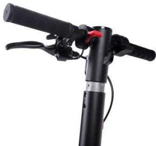
2). Nakon postavljanja rupa na upravljaču preko rupa na okviru umetnите vijke i dobro ih zategnite. Ponovite radnju i u suprotnom smjeru upravljača. Treba upotrijebiti sva 4 vijka.
