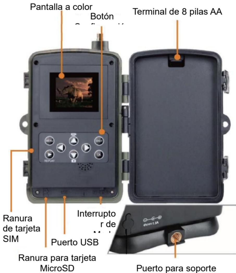
Abra la cubierta de las pilas; inserte 8 pilas AA manteniendo los signos de polaridad positiva y negativa y después cierre la cubierta de las pilas para resistir el agua y el polvo.
