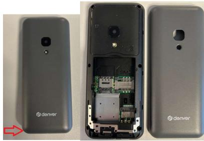
Inserire la scheda o le schede SIM nel supporto come indicato di seguito, con il chip rivolto verso il basso. Le schede SIM non sono incluse. Le schede SIM e il punto di contatto si danneggiano facilmente in caso di graffi e piegature. Prestare attenzione.
