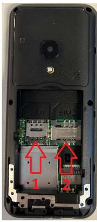
En option. Uniquement nécessaire pour les photos/vidéos de la caméra ou d'autres fichiers multimédias. Insérez la carte Micro SD (Max 32 Go) dans l'emplacement pour carte comme indiqué ci-dessous avec les contacts dorés orientés vers le bas. La carte Micro SD n'est pas incluse.
