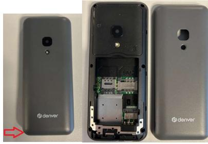
Insérez la ou les cartes SIM dans le support comme illustré ci-dessous, la puce tournée vers le bas. Les cartes SIM ne sont pas incluses. Les cartes SIM et le point de contact risquent d'être endommagés par les égratignures et le pliage. Veuillez faire attention.
