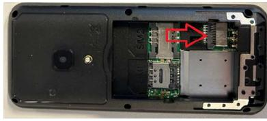
Insérez la batterie dans le compartiment à batterie.
