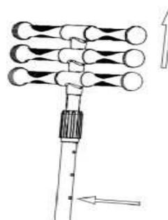
2. Pressione as esferas na vara e, em seguida, segure o guiador e puxe-os para cima e para baixo na direção indicada pela seta
