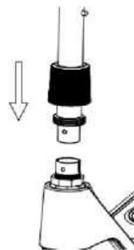
2. Ligue o tubo vertical à placa inferior e alinhe-o com o parafuso
