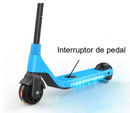
2. Empurrar suavemente para a frente com o outro pé. Quando alcançar a velocidade de 3 km/h, o motor emitirá um BIPE, ligando o motor.
