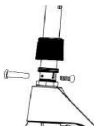
3. Aperte bem o parafuso com uma chave de parafusos
