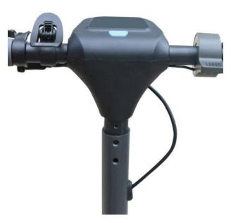
2). Faites correspondre les trous dans le guidon avec ceux du cadre, puis insérez les vis et serrez-les fortement. Répétez l'opération du côté opposé du guidon en insérant un total de 4 vis.
