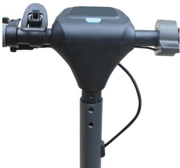
2). Nadat de gaten in het stuur zijn uitgelijnd met die in het frame, brengt u de schroeven aan en draait u deze goed vast. Herhaal deze handeling ook aan de andere kant van het stuur en gebruik in totaal 4 schroeven.
