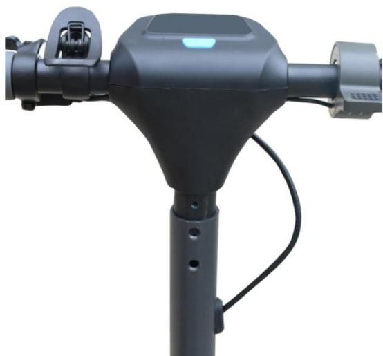
2). Tras hacer coincidir los agujeros en el manillar con los de la carrocería, inserte los tornillos y apriételos bien; repita también la operación en el lado opuesto del manillar insertando un total de 4 tornillos.
