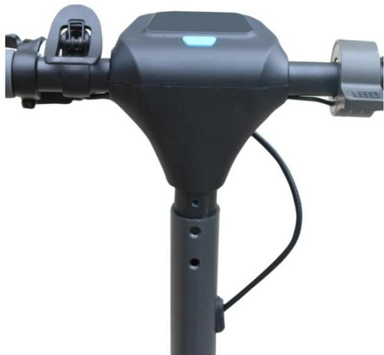
2). Depois de corresponder os orifícios no guiador com os da estrutura, inserir os parafusos e apertá-los bem; repetir a operação no lado oposto do guiador, inserindo um total de 4 parafusos.
