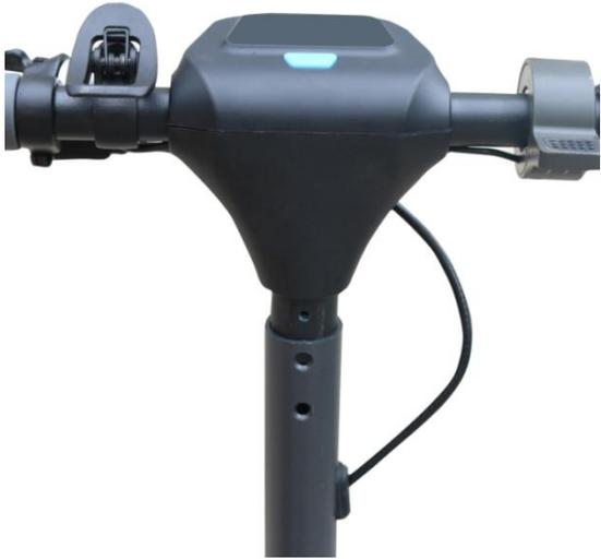
2). Nachdem Sie die Bohrungen des Lenkers mit denen des Rahmens ausgerichtet haben, setzen Sie die Schrauben ein und ziehen Sie sie fest an; wiederholen Sie den Vorgang auch auf der gegenüberliegenden Seite und setzen Sie insgesamt 4 Schrauben ein.
