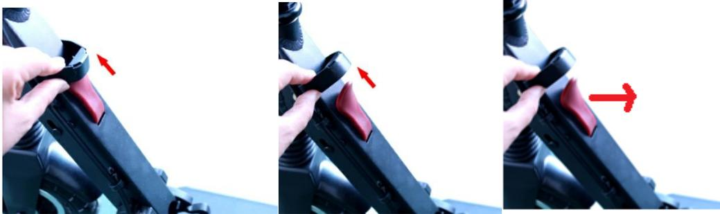
2) Presione hacia abajo el tubo delantero del scooter eléctrico.
