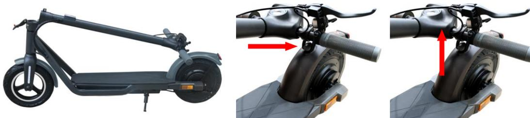
2) Levantar o punho de forma suave. Levantar lentamente o guidador.
