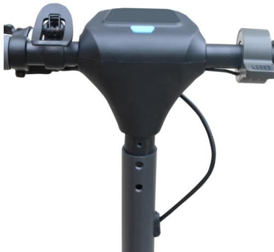
2). Depois de corresponder os orifícios no guidador com os da estrutura, inserir os parafusos e apertá-los bem; repetir a operação no lado oposto do guidador, inserindo um total de 4 parafusos.
