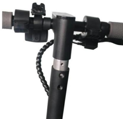
2). Depois de fazer coincidir os orifícios no guidador com os orifícios na estrutura, inserir os parafusos e apertá-los bem; repetir a operação também no lado oposto do guidador; são usados no total 4 parafusos.
