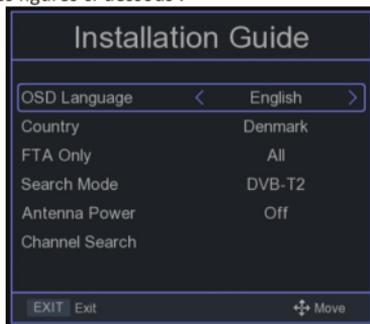
L'utilisateur peut sélectionner le langage OSD, Pays, FTA seulement, Mode Recherche, Alimentation Antenne, Recherche de canal dans ce menu ; quand c'est fait, l'utilisateur peut choisir « Recherche de canal » et appuyer sur « OK » pour rechercher les canaux comme indiqué dans l'illustration ci-dessous :
