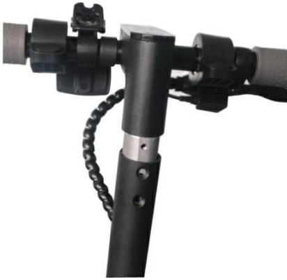
2). Cuando coincidan los orificios del manillar con los del bastidor, inserte los tornillos y apriételes bien; repita la misma operación en el lado opuesto del manillar; son necesarios 4 tornillos en total.
