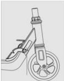
Premere con decisione il fermo pieghevole (il fermo pieghevole permette di regolare la tenuta).
