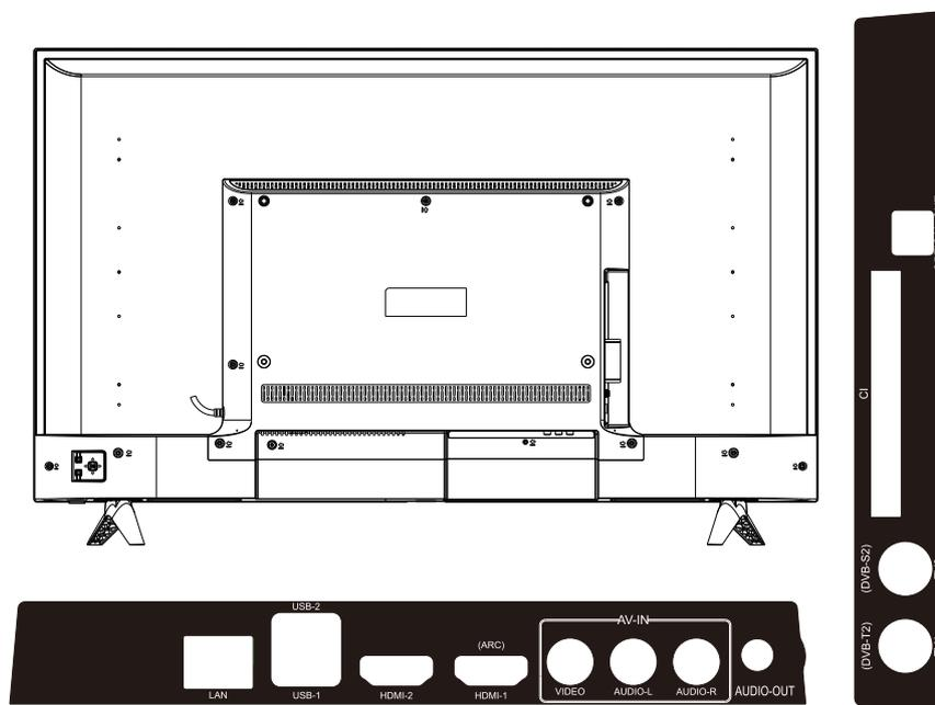
**LAN (RJ45)** : prise RJ45 pour la connexion à un modem externe ou à un équipement d'accès au réseau.
