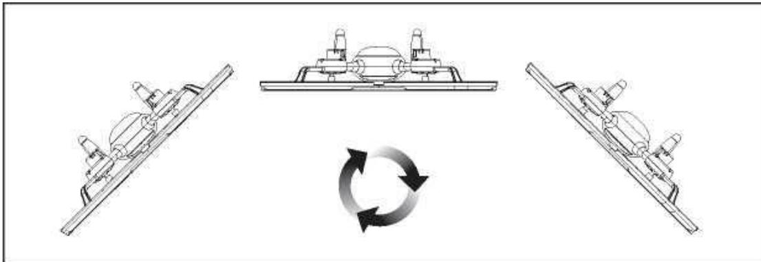
Drücken Sie die Überschlagstaste, damit hören Sie zwei Signaltöne. Bewegen Sie den rechten Joystick, um das Fluggerät zum Überschlag zu bringen. Wenn Sie den Joystick nach links bewegen, fliegen Sie einen linken Überschlag. Wenn Sie den Joystick nach rechts bewegen, fliegen Sie einen rechten Überschlag.
