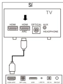
Utilice un cable HDMI (V1.4 o superior) para conectar la barra de sonido a la toma ARC del TV.
