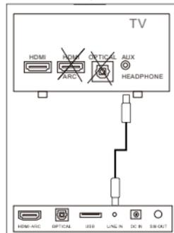
Conecte la toma LINE IN de la barra de sonido al TV con el cable auxiliar suministrado.
