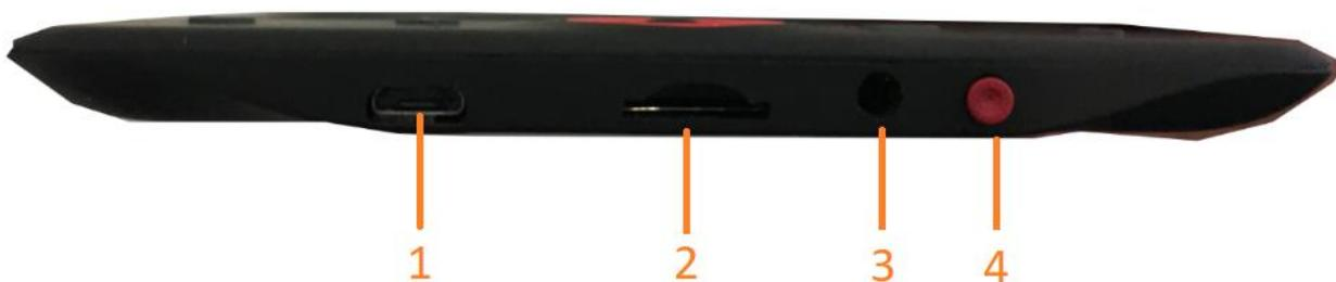
1. Connessione via cavo USB per caricare e trasferire file.
