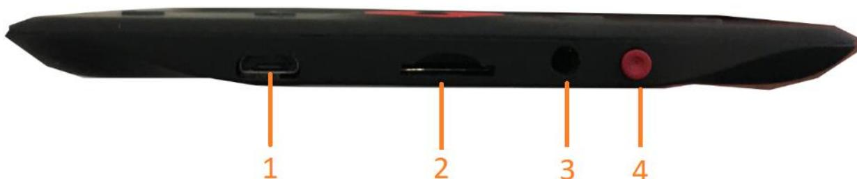
1. Conexión del cable USB para la carga y la transferencia de archivos.
