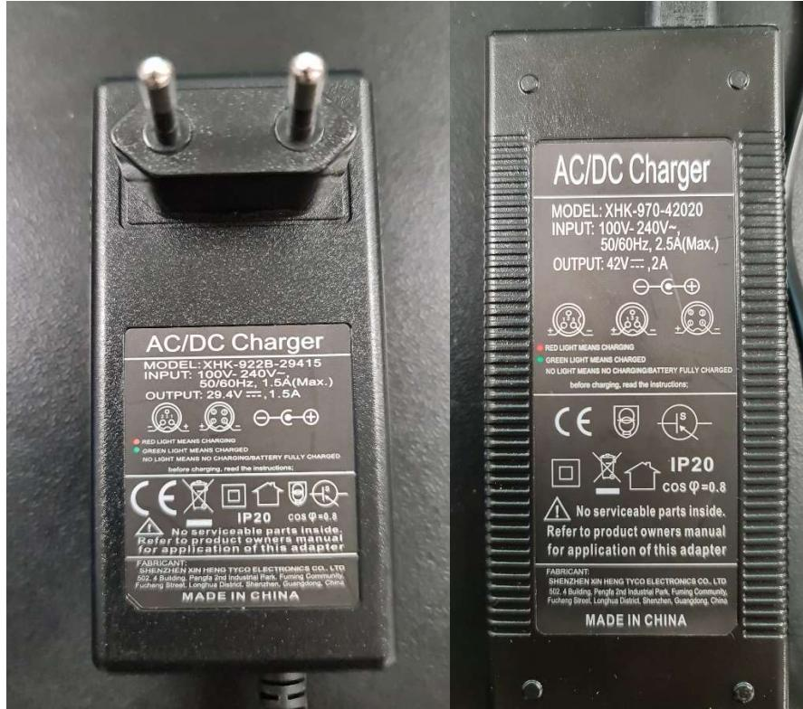
Denne modellen har en adapter med strømkutt-funksjon (adapteren vil slås av så snart batteriet er fulladet), som en ekstra sikkerhet for å unngå overlading.
