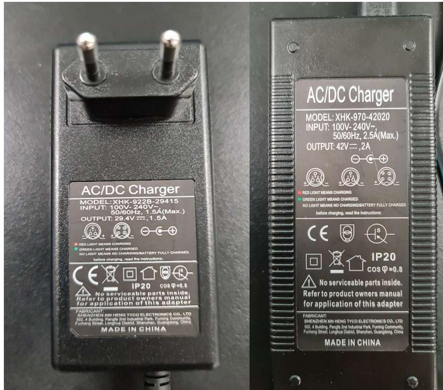
Este modelo tiene un adaptador con función de corte (el adaptador se apaga poco después de que la batería se cargue completamente) como medida adicional de seguridad para prevenir un mal funcionamiento.
