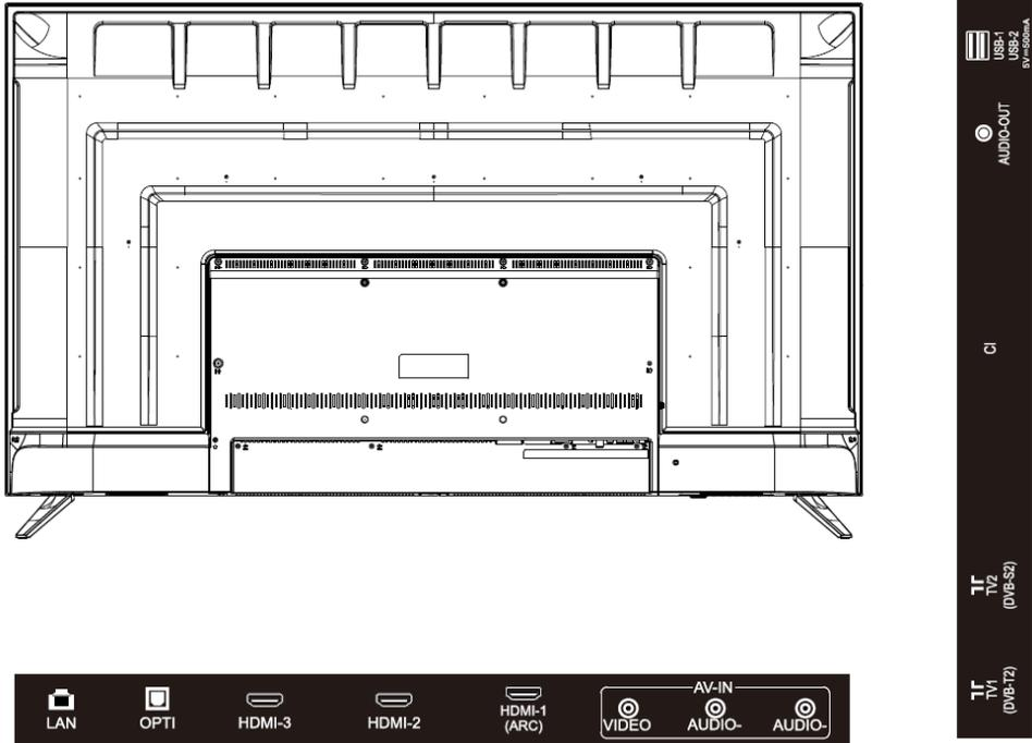
**Puerto LAN (RJ45):** Conecte una toma RJ45 a un modem externo o un equipo de acceso a red.
