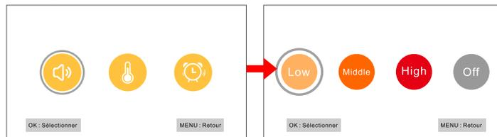
**Remarque :** L'alarme sonore dure 1 minute. L'alarme sonore peut être désactivée en appuyant sur toute touche du moniteur. Dans les 3 minutes suivant la désactivation de l'alarme, si un autre son est à nouveau détecté, le moniteur ne déclenche pas d'alarme pour éviter un rappel fréquent.
