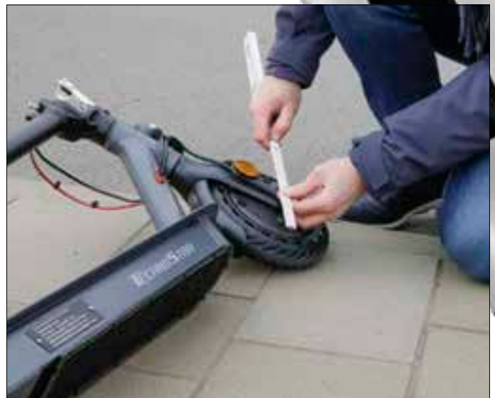
Größe und Art der Reifen haben einen großen Einfluss auf den Komfort. Die beste Mischung bietet Denver: 23 cm Durchmesser und luftgefüllte Pneu.
