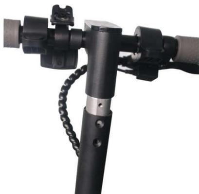
2). Dopo aver fatto combaciare i fori del manubrio con quelli del telaio, inserire le viti e serrare bene; ripetere l'operazione anche sul lato opposto del manubrio; vengono utilizzate complessivamente 4 viti.
