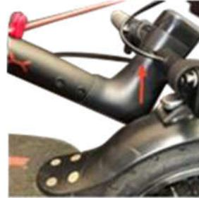
2) Richten Sie das Steuerrohr vorsichtig auf. Heben Sie dabei den Griff langsam an. Schließen Sie den Verriegelungshebel am unteren Ende der Steuerrohraufnahme.
