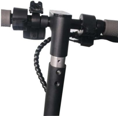
2). Wenn die Schraubenbohrungen der Lenkerstange deckungsgleich zu den Schraubenbohrungen des Steuerrohres liegen, dann stecken Sie die Schrauben hindurch und ziehen Sie ordnungsgemäß fest. Wiederholen Sie den Schritt auf der gegenüberliegenden Seite der Lenkerstange. Insgesamt sind 4 Schrauben zu verwenden.
