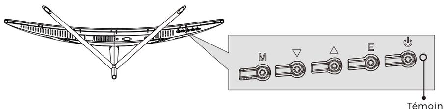
Une lumière bleue constante indique que le moniteur est sous tension et qu'il fonctionne normalement. Une lumière bleue clignotante indique qu'aucune source vidéo n'a été détectée. Une lumière rouge indique qu'aucun signal horizontal ou vertical n'a été détecté, ou que la tension est faible. Veuillez vous assurer que votre ordinateur est allumé et que tous les câbles vidéo sont complètement insérés ou bien connectés.
