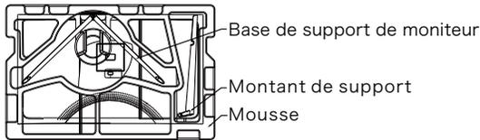
2. Prendre les deux parties du support, retirer la mousse recouvrant l'arrière du moniteur, et appuyer sur le bouton pour retirer la plaque de support.
