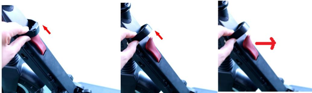
2) Poussez le tube avant du scooter électrique vers le bas.
