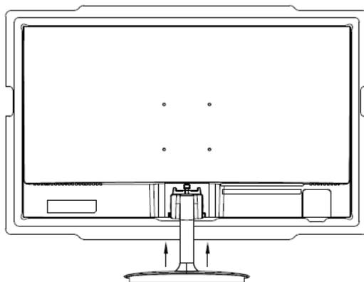
Colocar o suporte junto da estrutura traseira e levantar.
