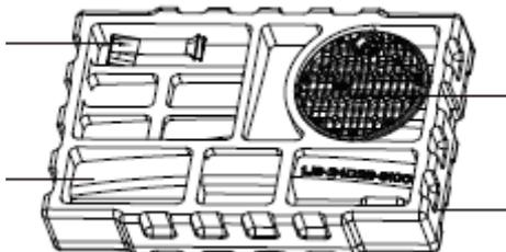
2. Rodar o suporte para um determinado ângulo e alinhar o mesmo com a ranhura circular da base, encaixar o mesmo com firmeza e depois rodar no sentido horário para fixar o suporte na base para completar a instalação da mesma.
