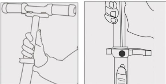
Ouvrez le verrou de réglage d'une main et ajustez la tige télescopique à la hauteur souhaitée avec l'autre main. Les usagers doivent ajuster la hauteur du produit à la position appropriée pour assurer une conduite sans risque.
