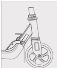
Appuyez fermement sur le verrou rabattable (il permet de régler le serrage).
