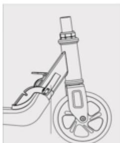
Premere con decisione il fermo pieghevole (il fermo pieghevole permette di regolare la tenuta).
