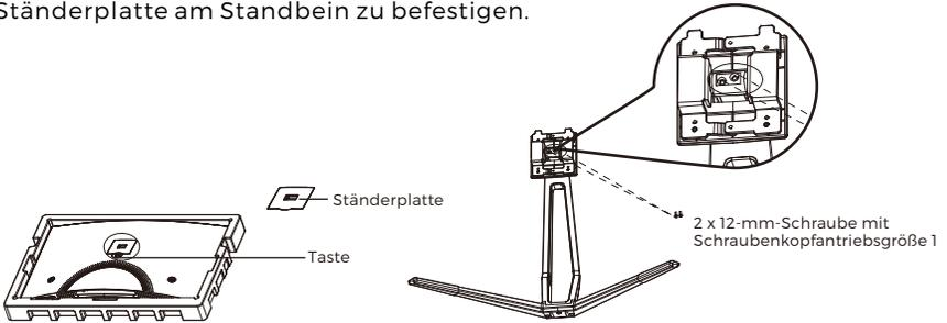
3. Stecken Sie die Ständerplatte in die Öffnung auf der Rückseite des Monitors. Das richtige Einrasten wird durch ein Klicken signalisiert. Stellen Sie sicher, dass der Ständer sicher an der Rückseite des Monitors befestigt ist und entfernen Sie dann das restliche Polystyrol vom Monitor. Stellen Sie den Monitor anschließend auf einem Tisch oder Schreibtisch auf.
