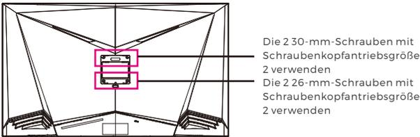
**!** - Verwenden Sie für diese Montagevariante nur die mitgelieferten Schrauben mit Schraubenkopfantriebsgröße 2 (2 x 30 mm, 2 x 26 mm).
