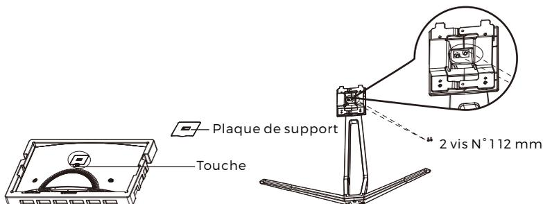
3. Insérer la plaque de support dans l'ouverture à l'arrière du moniteur. Il doit cliquer quand il est en place. S'assurer que le support est bien fixé sur l'arrière du moniteur, puis retirer la mousse restante du moniteur, et le poser sur une table ou un bureau.
