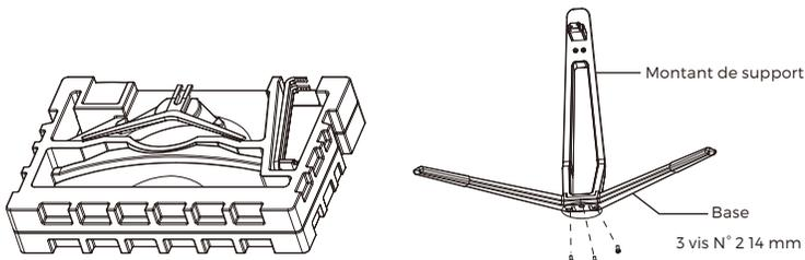
2. Retirer la mousse recouvrant l'arrière du moniteur, puis appuyer sur le bouton pour retirer la plaque de support. Utiliser ensuite deux vis N° 1 pour fixer la plaque de support sur le montant.
