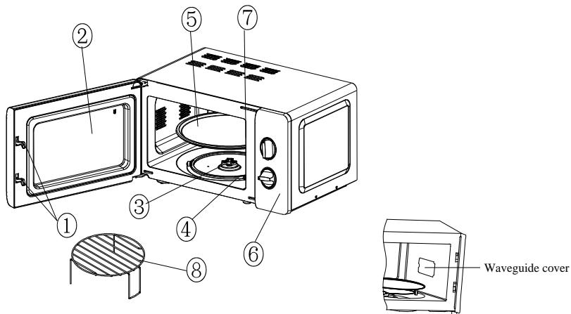
Cubierta del guía de ondas
