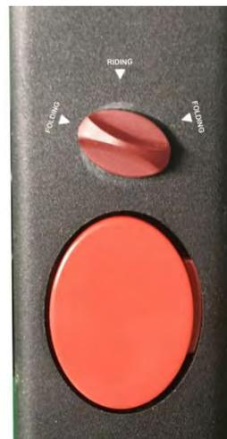
Premere il pulsante rosso per chiudere o aprire l'e-scooter. Ruotare la manopola di sicurezza sulla posizione "Pieghevole" sulla destra o sulla sinistra. È possibile premere il pulsante rosso per piegare l'e-scooter. Ruotare la manopola di sicurezza in posizione "CORSA", per poter iniziare a guidare.
