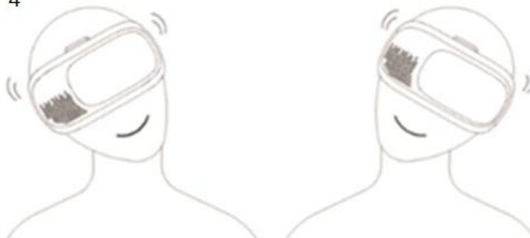
4. Si la APLICACIÓN VR APP y el teléfono son compatible con la función del giroscopio. Entonces puede controlar el ángulo de visión inclinando la cabeza.
