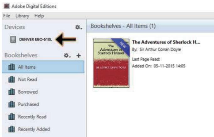
10. Parfois, il est nécessaire d'autoriser DENVER EBO-610L. Cela se fait en cliquant sur l'icône engrenage en face de Devices et choisir «authorize device».
