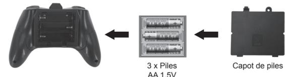
**Installation des piles:** Ouvrez le couvercle du compartiment à piles, insérez 3 piles AA 1,5 V en respectant les polarités (piles non incluses).
