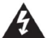
Le symbole de l'éclair à l'intérieur d'un triangle équilatéral, sert à avertir l'utilisateur de la présence dans le boîtier de l'appareil de pièces non isolées sous tension d'une intensité pouvant constituer un risque d'électrocution.
