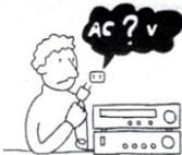
Power Source - Dieses Gerät sollte nur mit der auf dem Typenschild angegebenen Netzspannung betrieben werden. Wenn Sie sich nicht sicher sind, über welche Art von Spannung Ihr Stromnetz verfügt, wenden Sie sich an Ihren Händler oder an ein regionales Stromversorgungsunternehmen. Hinweise für Geräte, die mit Batteriestrom betrieben werden, finden Sie im Benutzerhandbuch.
