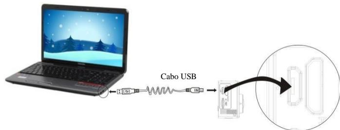
Ligue a câmara ao computador para carregar. Nesta altura, o indicador de carregamento ficará vermelho e desligará depois do carregamento. Geralmente, o carregamento da bateria demora 2-4 horas.
