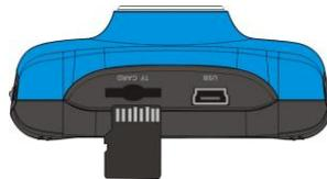
**Seguire le seguenti avvertenze: le schede UHS (Ultra High Speed, a velocità ultra) non funzionano poiché non sono completamente compatibili con i sistemi di generazione precedente.**
