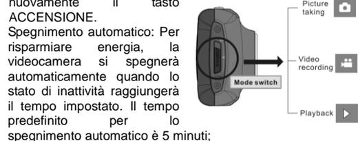
Spegnimento automatico: Per risparmiare energia, la videocamera si spegnerà automaticamente quando lo stato di inattività raggiungerà il tempo impostato. Il tempo predefinito per lo spegnimento automatico è 5 minuti;
