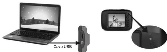
Quando la videocamera è spenta e connessa al computer, la batteria si carica. L'indicatore luminoso di carica si spegnerà a caricamento completato. La batteria sarà totalmente carica dopo 2-4 ore.
